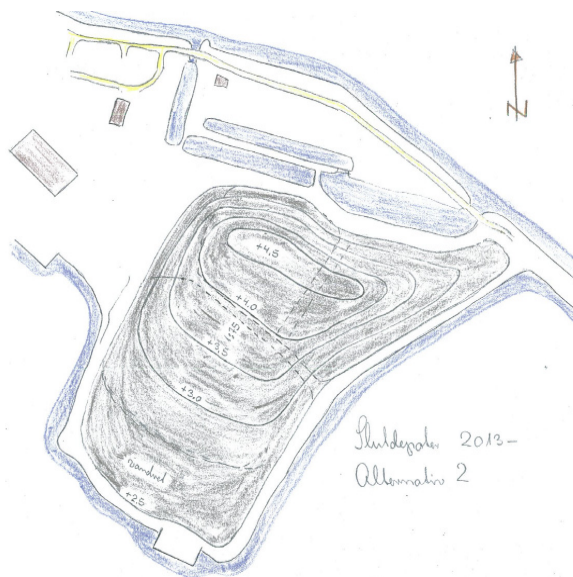
Skitseforslag til terrænregulering, der sikrer, at solfangeranlæg kan placeres på en sydvendt skråning.
