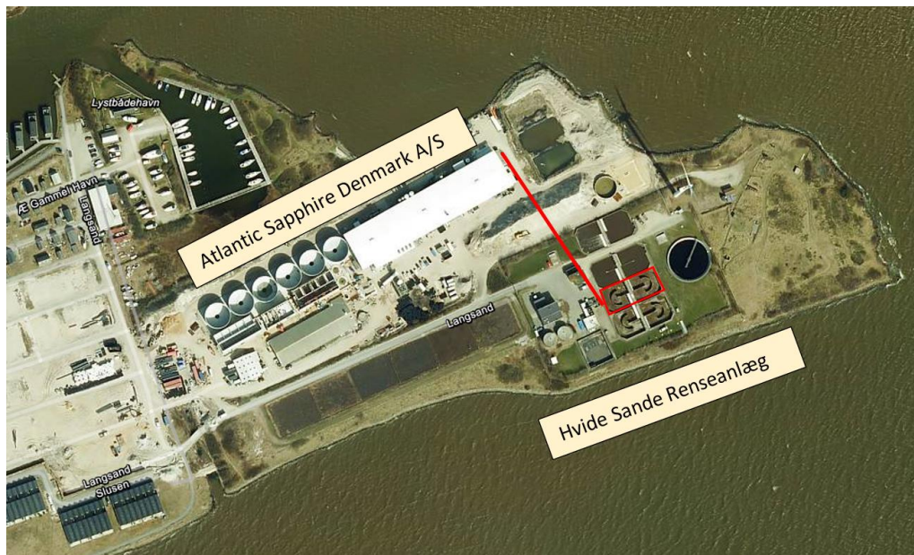
Figur 1 Illustration af virksomheden som tilsluttes direkte til Hvide Sande Renseanlæg, hvor den røde linje er den planlagte trykledning og det røde rektangel er den eksisterende ringkanal, som virksomheden lejer af Ringkøbing-Skjern Forsyning A/S
