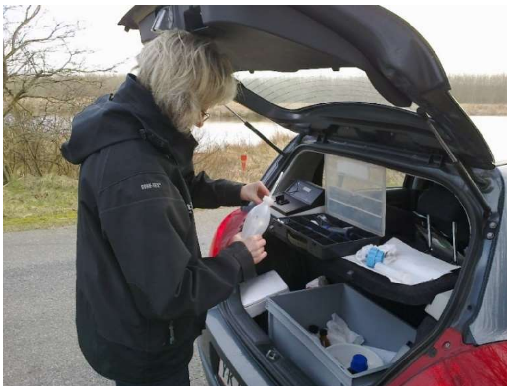
Figur 13. Jernprøver fra de okkerbelastede vandløbsstrækninger bliver analyseret i det "rullende laboratorium".
