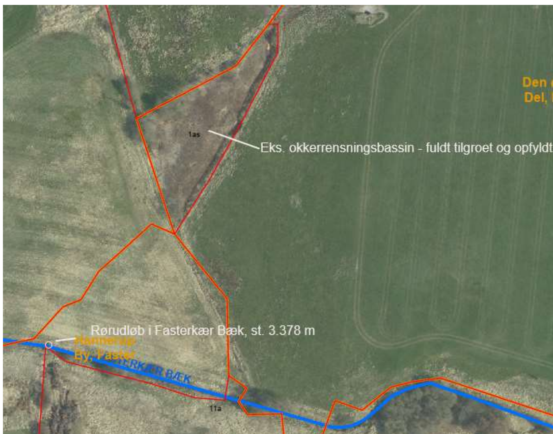
Figur nr. 20. Luftfoto der viser tilgroningen af det gamle okkerrensingsanlæg ved rørtilløbet
