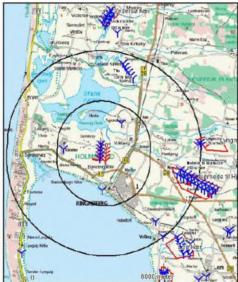
Kort 0.1. Placering af ansøgte vindmøller i Rindum øst for eksisterende vindmøller i Vognkær samt øvrige rammeområder for vindmøller (rød) og eksisterende eller planlagte vindmøller (blå vindmøllesignatur) i forhold til nærzone og mellemzone omkring de ansøgte møller i Rindum Enge.
